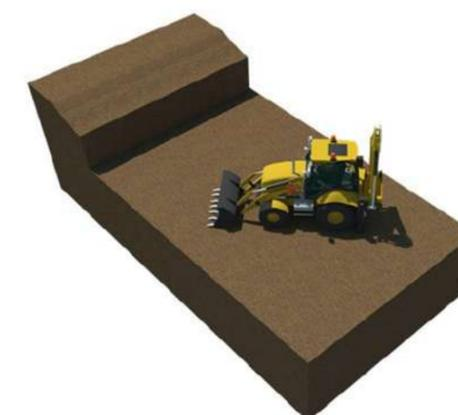
Ambos os cortes devem ser muito bem planejados e executados para que não ocorra deslizamentos de terra durante a execução do muro. Verifique a empresa que realizará os cortes, a sua reputação, funcionários e maquinários.
