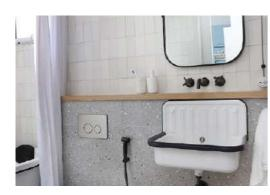
Assim como a cuba de piso, a cuba de parede também dispensa a necessidade de bancada, otimizando ainda mais o espaço do banheiro. Na versão da cuba de parede por sua vez os sifões ficam visíveis e a torneira normalmente é de bica baixa e fixada na própria estrutura da cuba.
