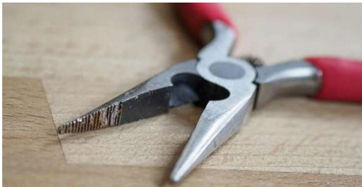
Não subestime a capacidade de um alicate. Esse item simples pode ser mais fundamental na sua caixa de ferramentas do que você pode imaginar. Com ele é possível cortar e descascar fios elétricos e de antena, cortar arames, apertar parafusos, entre outras inúmeras
