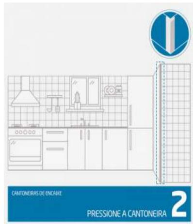
Usando as mãos, pressione a cantoneira para mantê-la corretamente fixada na argamassa e revestimento.
