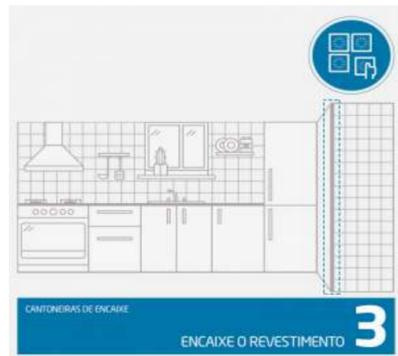
Agora é hora de continuar o assentamento do revestimento do outro lado da parede a partir da cantoneira; ou seja, assente o revestimento acima da base da cantoneira, encaixando bem o revestimento contra a cantoneira para não deixar um vão.
