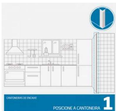
Já finalizou o assentamento do revestimento de um dos lados da parede? Se sim, agora é a hora de posicionar a cantoneira na argamassa da quina encaixando-a no revestimento que já foi assentado.
