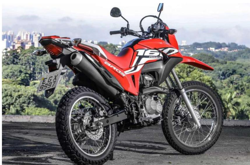
A Bros 160 é uma aventureira urbana bem acessível e que parte de R\$ 14.600, compartilhando com a CG 160, o motor monocilíndrico de 4 tempos OHC de 162,7 cm<sup>3</sup>, mas com 14,5 cavalos na gasolina e 14,7 kgfm no etanol.
