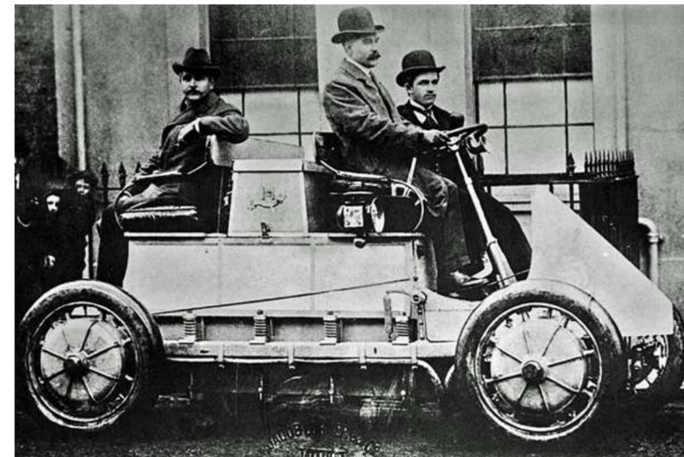
O Elektromobil tinha um motor elétrico em cada uma das quatro rodas e um motor a combustão que funcionava como um gerador para recarregar as baterias. Assim, ele era do tipo híbrido em série. 300 unidades foram vendidas, e ao longo do século XX diversas alternativas de híbridos e elétricos passaram pela história do automóvel, muitos vendendo diversas unidades.
