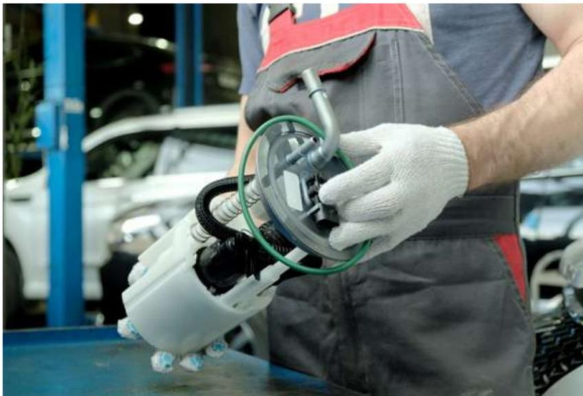
A bomba de combustível é refrigerada pelo líquido que passa por dentro dela e não pelo que está em volta, armazenado no tanque (Foto: Shutterstock)
